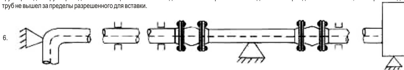
7. Гибкие вставки следует устанавливать непосредственно за неподвижной опорой. За гибкой вставкой следует предусмотреть подвижные опоры.
