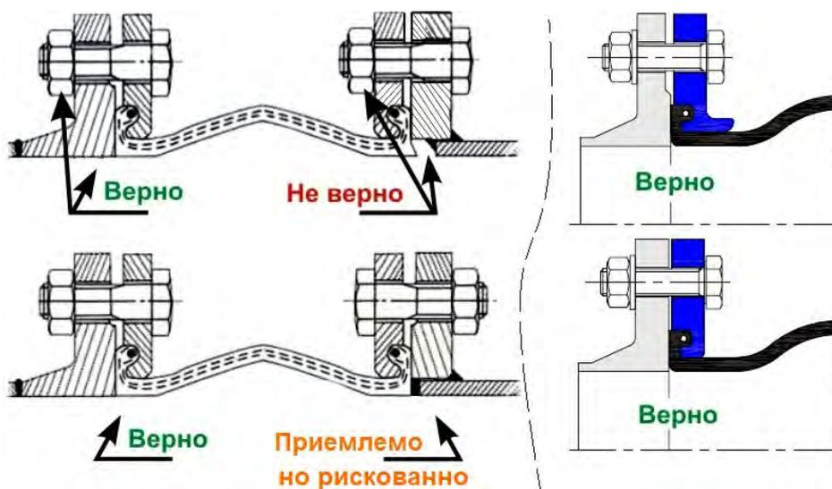
20. При установке виброкомпенсатора ABRA при необходимости можно смазать поверхности трения мыльной водой (не маслом ни в коем случае).
