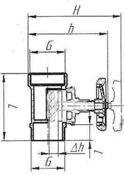
Рисунок 2 – Внешний вид прямогочной модели КТЧП, КТЧП и КТЧК.
